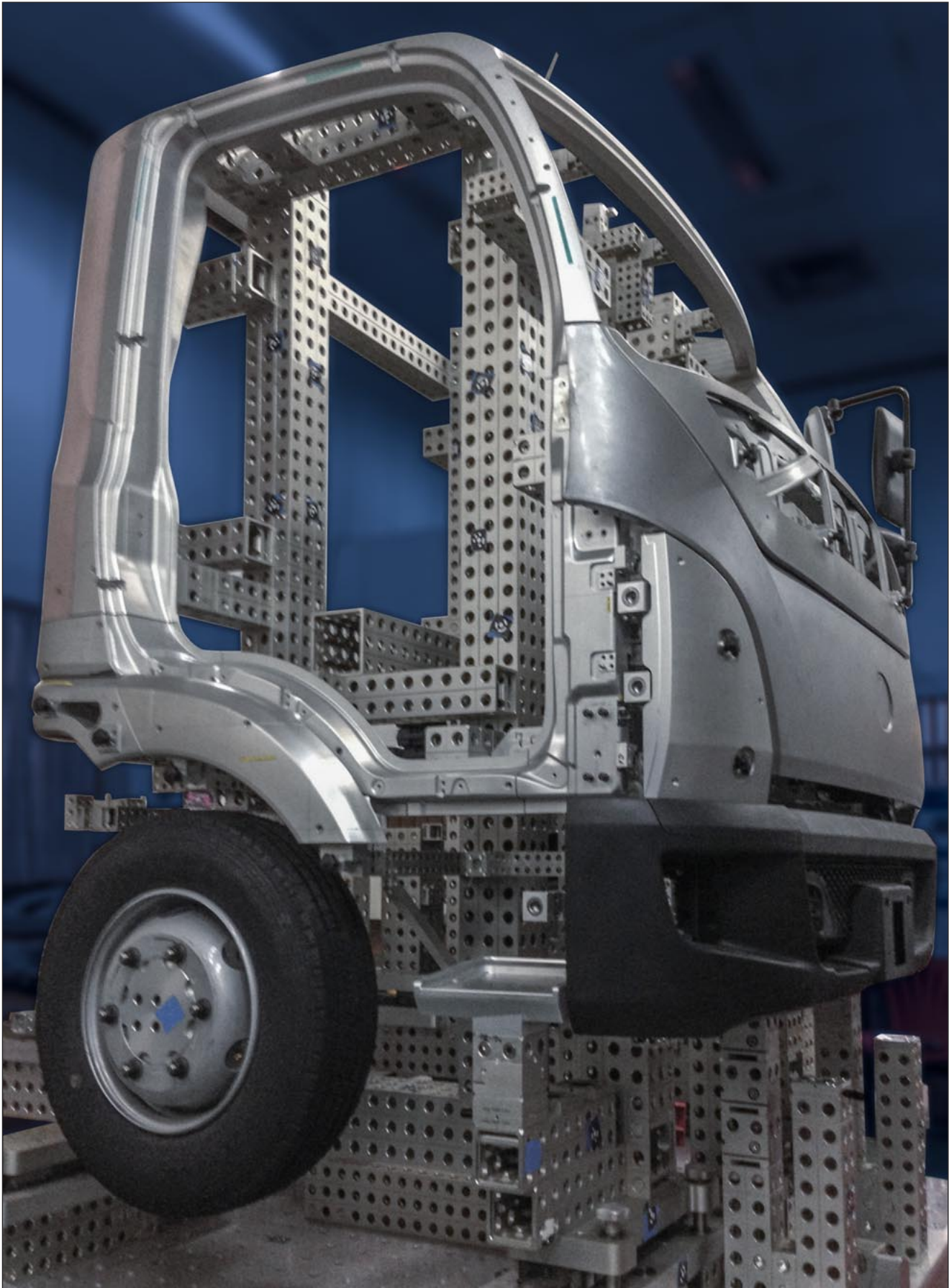
Anwendungsbeispiel: Vorrichtung für einen Lkw mit ALUFIX Light Classic Quadern.
