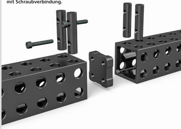
Stirnseitiges Koppeln von ECO Plus Quadern mit Schraubverbindung.
